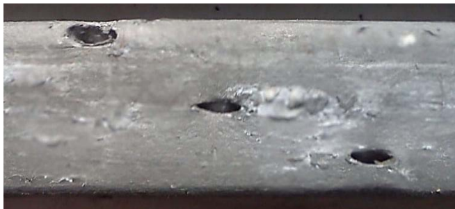
Рис. 1. Вид деформированных пор на боковой поверхности ( \varepsilon = 25\% )
